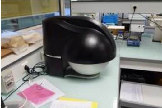
Prise d'image avec une caméra multispectrale VideometerLab3
