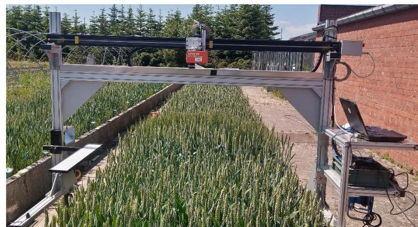
Acquisition de données spectrales de la canopée avec Specim FX17
